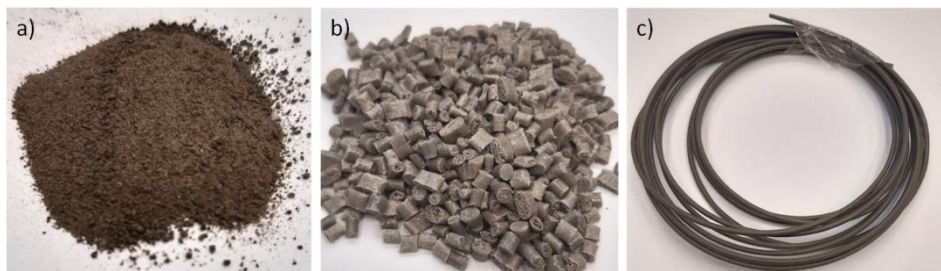
Rys. 1. Etapy wytwarzania filamentu napelnionego regolitem: a) suszenie regolitu, b) wytwarzanie granulatu, c) wytłaczanie gotowego filamentu
