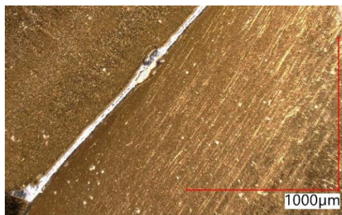
Rys. 1. Początkowa postać zużycia ściernego głównej krawędzi skrawającej
